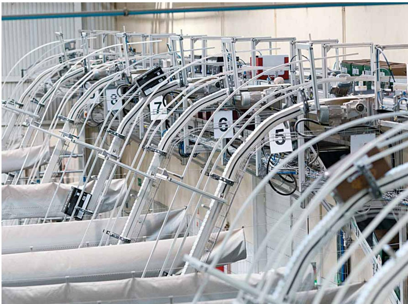
Bei traditionellen Systemen erfordern großvolumige Produkte Gleitkurven mit großem Radius und Reibungsfaktor. Rexroth bietet eine Alternative: Rollreibung durch die kugelgelagerte Kurve. Das bedeutet weniger Friktion, weniger Verschleiß, weniger Energiebedarf, höhere Belastung.
